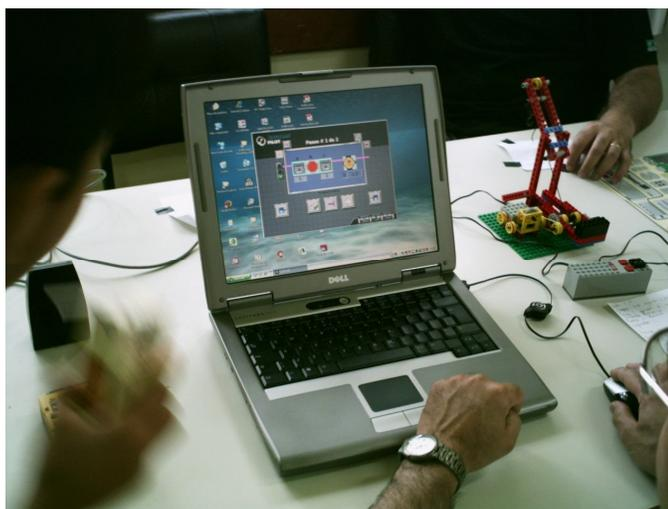
Foto 9: Computador conectado controlando os movimentos da montagem.
